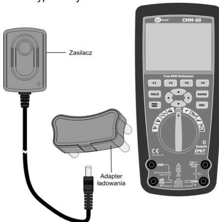
Akumulator w trakcie ładowania
